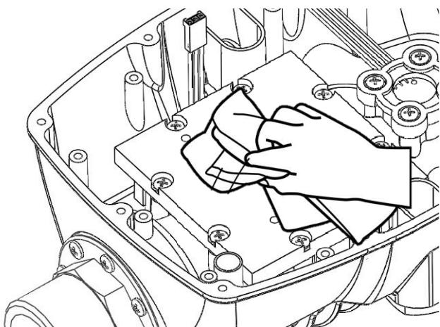
J.2) Для соединения с радиатором, нанесите тонкий слой теплопроводящей пасты на верхнюю поверхность IGBT модуля и на диодный мост.
