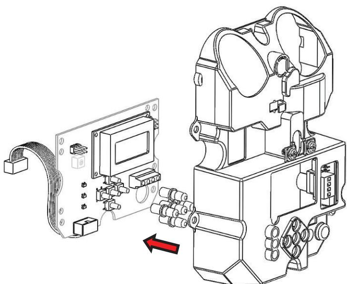
E.1) Установите новую плату. Проверьте правильность установки удлинений для кнопок и закрутите 4 болта, фиксирующих плату. Затем соберите устройство, повторив описанную выше процедуру, но в обратном порядке.
