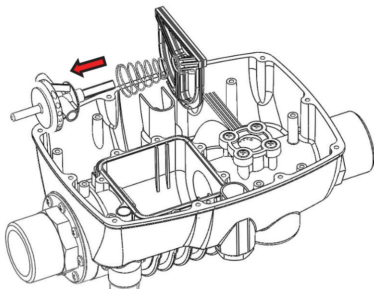
С) Помойте клапан сжатым воздухом. Если на элементах клапана есть малейшие трещинки, замените клапан полностью. Заново установите клапан и пружину с направляющей опорой. Убедитесь, что каждая часть находится на своем месте. В опоре с одной стороны только одно центральное кольцо для пружины, а клапан имеет ориентир для правильного размещения.
