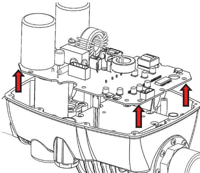
H.2) Отсоедините датчики потока и давления. Не тяните за кабели, чтобы отстыковать разъемы!
