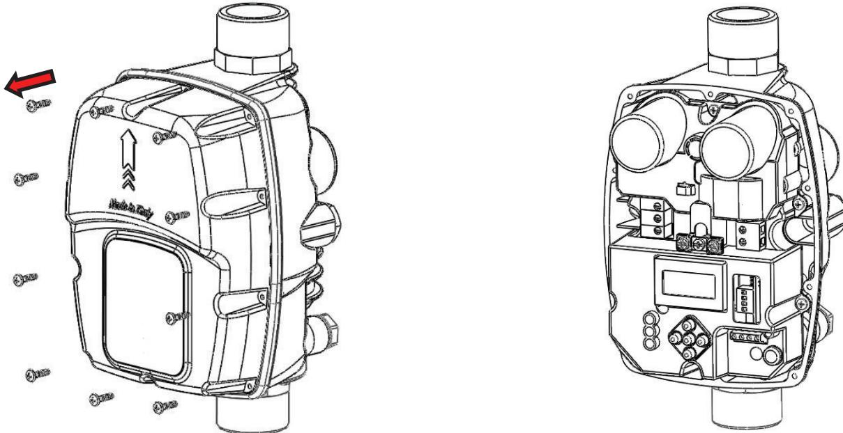
Б) Открутите болт (находится посередине), крепящий пластину с клеммами заземления, и шесть болтов крепления внутренней крышки.
