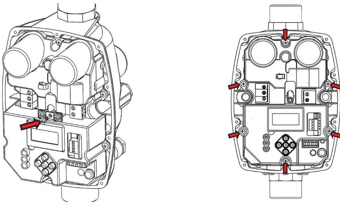
С) Медленно и аккуратно приподнимите внутреннюю крышку с платой дисплея, при этом следите, чтобы плоский кабель, соединяющий плату дисплея и плату питания, при этом не выдернулся. Приподняв крышку, отстыкуйте плоский кабель и отделяте внутреннюю крышку с платой дисплея от корпуса с платой питания.
