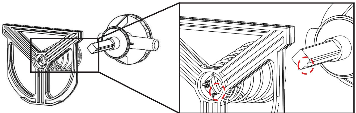
Д) Установите клапан с пружиной на прежнее место внутри устройства. Сначала вставьте цилиндрический штифт клапана, затем вставьте скользящим движением клапан и поставьте опору на свое место.
