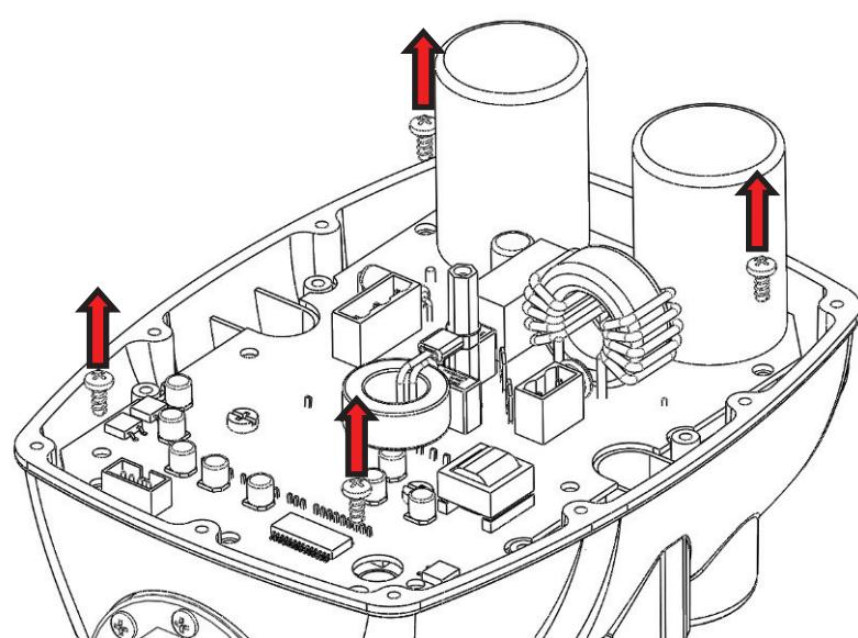
E.2) Открутите верхний шестигранный латунный винт и отсоедините желто-зеленый провод заземления.
