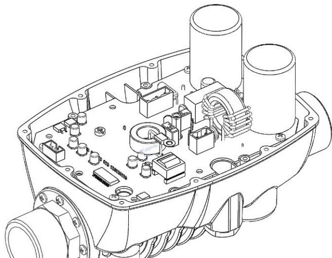
F.2) Открутите нижний шестигранный латунный штифт и удалите 2 болта, фиксирующих IGBT модуль.
