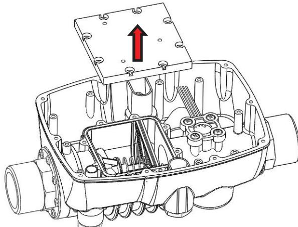
Б) Вытащите направляющую опору клапана, потянув ее вверх и вперед по направлению к датчику давления. Сдвинуть клапан и пружину по продольной оси, чтобы можно было вытащить их из корпуса.
