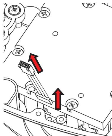
В) Вставьте новый датчик потока. При этом микросхема датчика должна быть направлена во внутрь (по направлению к клапану).
