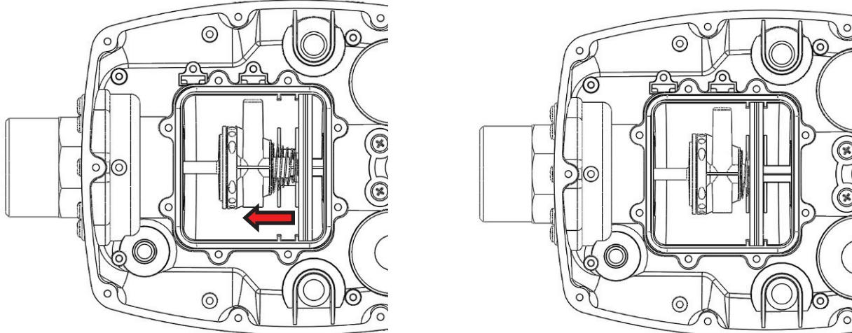
Е) Убедитесь, что клапан плавно двигается в обоих направлениях. Проверьте, чтобы пружина была правильно отцентрована в клапане и опоре.
