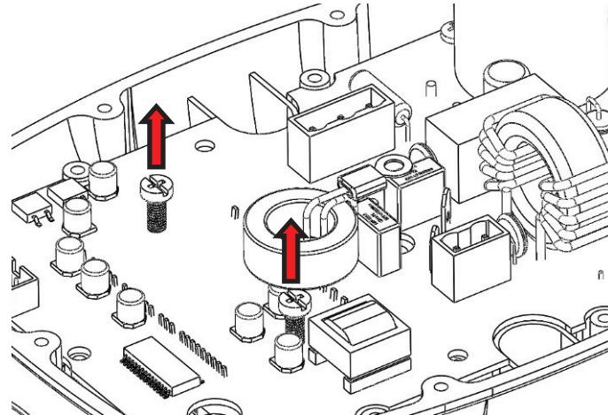
G.2) Медленно приподнимите плату питания, убедившись, что кабели, соединяющие датчики питания и потока, не выдернулись. Если необходимо, слегка подвигайте плату в противоположных направлениях, чтобы разрушить слой теплопроводящей пасты, которая нанесена между радиатором и IGBT модулем.
